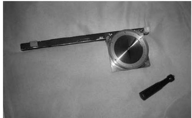
Abb. 6a: Präziser ("Bergbau"-) Magnetkompass mit bis 1 Grad genauer Ablesung und einer etwa 40 cm langen Spezialanpassung. Photo: © J. Klokočník, 2010. Von Doz. Radim Blažek, Geodätische Fakultät, TU Prag, Tschechische Republik für unsere Messungen freundlich zur Verfügung gestellt.
